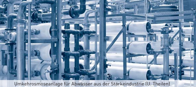
Umkehrosmoseanlage für Abwässer aus der Stärkeindustrie (U. Theilen)
